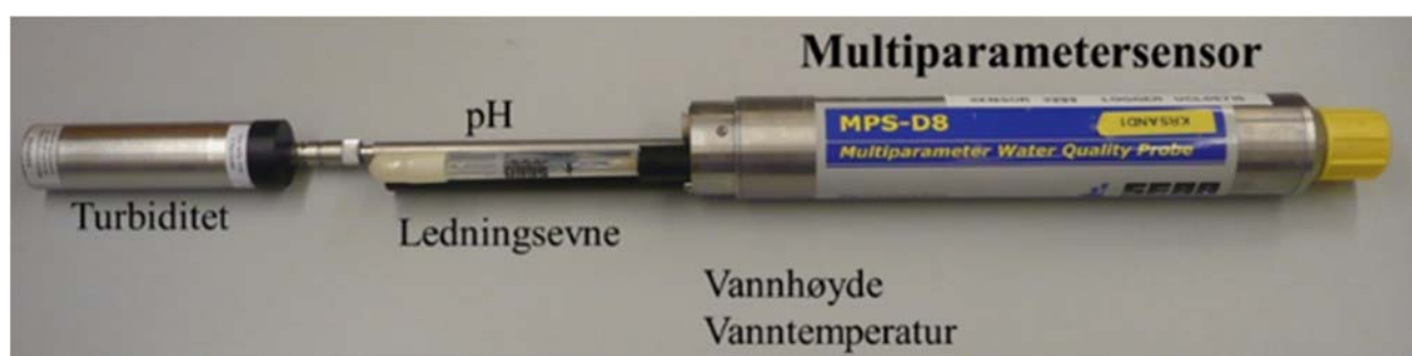
Figur 2: Multiparametersensor for automatisk overvåking av vannkvalitet.
