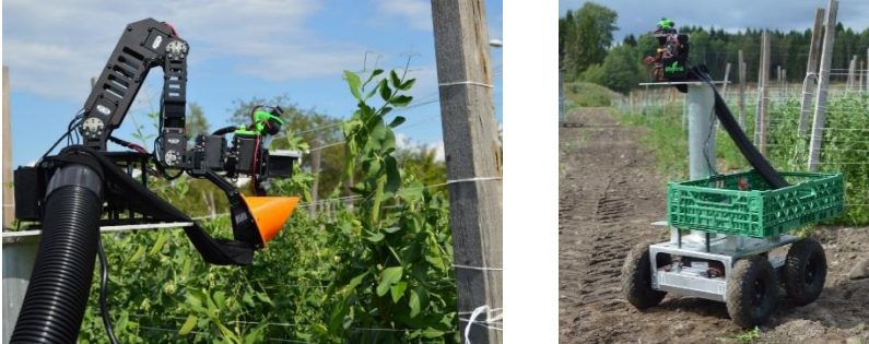
Bilde 10. Robot for plukking av sukkererter
