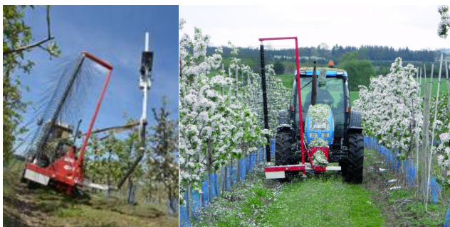
Bilde 8. Darwin; traktormontert system for tetthetsjustert tynning av fruktblomster
