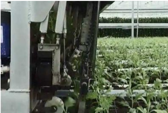
Bilde 1. RoBoPlant; robot for planting av blomsterplanter
