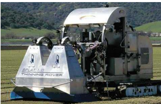
Bilde 5. Splat 1.0 Thinning Rover; robot for tynning av salat og grønnsaker
