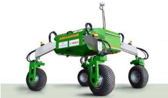
Bilde 18. BoniRob; modulbasert robot
