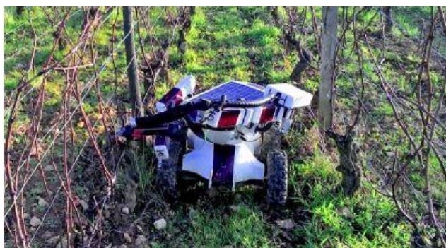
Bilde 7. Wall-Ye 1000; robot for beskjæring av vinplanter
