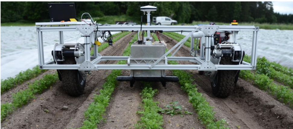
Bilde 4. Robot for mikrodråpesprøyting av ugras i radkulturer
