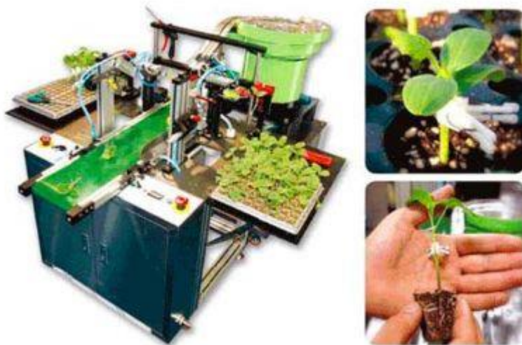
Bilde 2. GR-600CS; robot for poding av grønnsakplanter- og frukttrær
