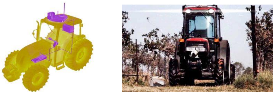
Bilde 21. ASI skid steer; løsning for autonom styring eller fjernkontroll av traktor
