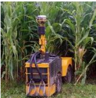
Bilde 19. Rowbot; robot for gjødsling og såing i mais
