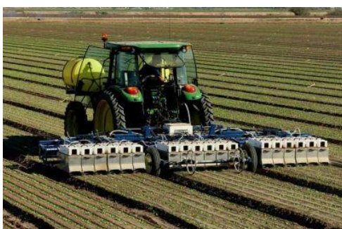
Bilde 6. LettuceBot2; utstyr for salattynning og ugrassprøyting
