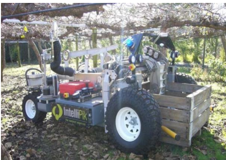
Bilde 13. IntelliPick; robot for plukking av kiwifrukt
