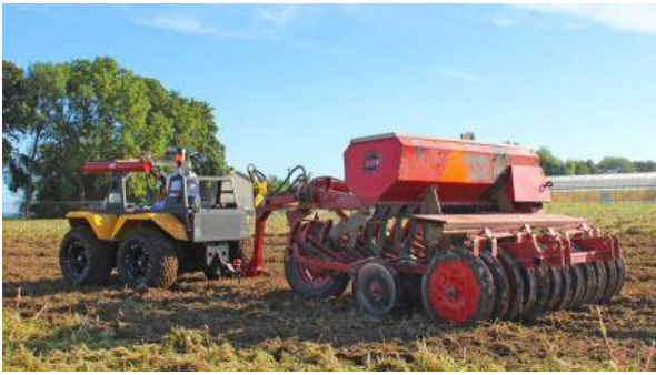
Bilde 17. Grizzly; universal robot her trekkende på ei såmaskin
